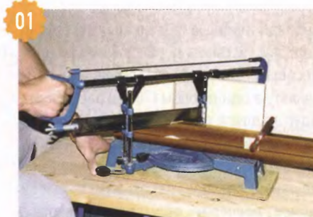
01 При раскрое профилированного бруска для дверной коробки нужно точно выставить его в стусле и надёжно закрепить, используя деревянные подкладки.
